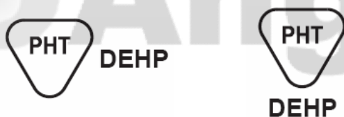
圖一、高DEHP暴露風險PVC材質醫療器材之最小販售包裝標示符號
